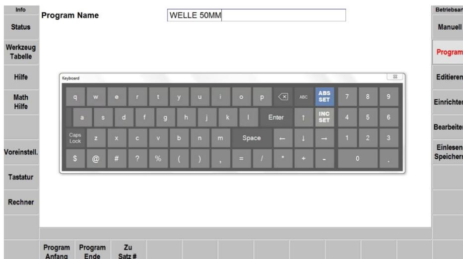
**Abbildung 8.3** Das erste Fenster (Satz 0) mit der geöffneten Tastatur zur Eingabe des Programmnamens.
