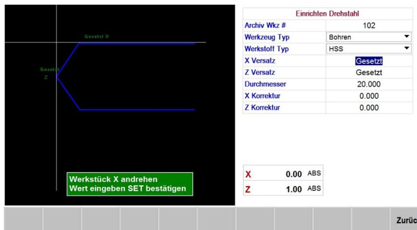
**Abbildung 6.3.3** Bohr-Werkzeuge einrichten
