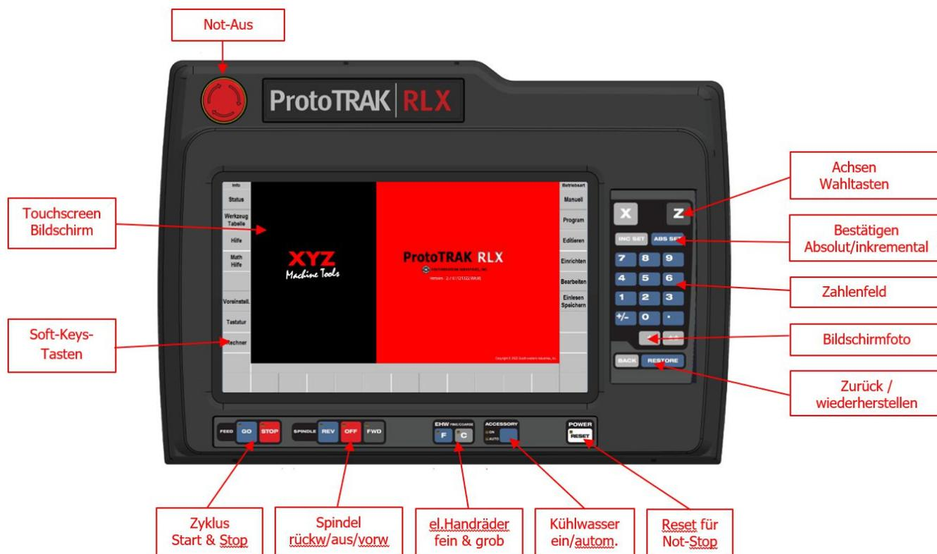
Abbildung 3.3.1 Die Vorderseite der ProtoTRAK RLX Steuerung
