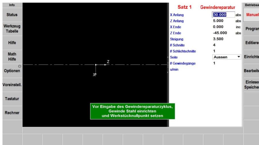
**Abbildung 7.8.4(1)** Die erste Seite des Gewinde-Reparatur-Zyklus
